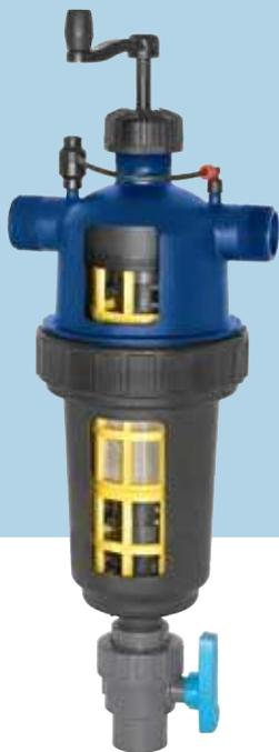
Полуавтоматические, сканирующего всасывания, пластиковые фильтры компании NaanDanJain предлагают разумные и экономически эффективные решения ручной очистки фильтров для оросительных систем. Легкий поворот ручки позволяет быстро и эффективно очистить фильтр.
