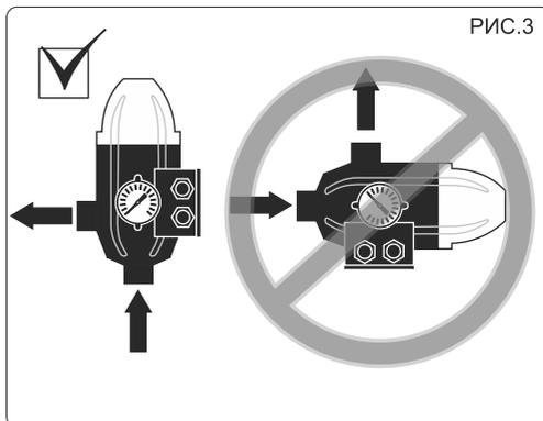
**Внимание:** Допускается только вертикальная установка реле. В любом другом положении оно не будет функционировать (рис.3).
