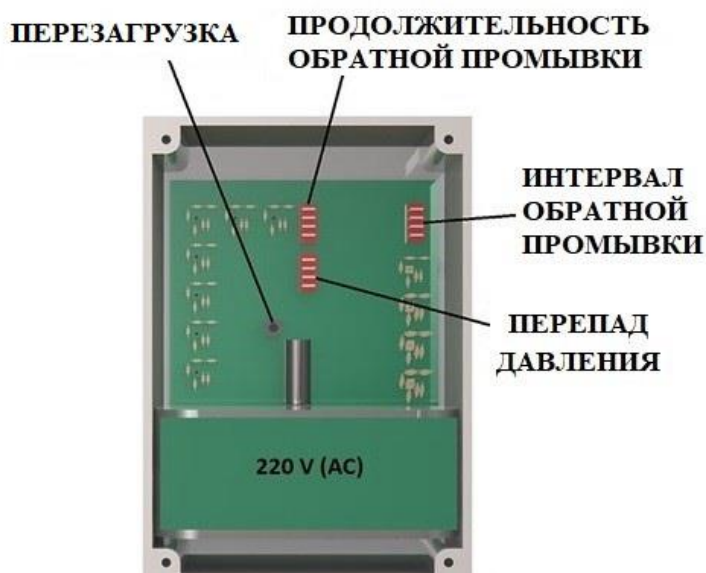
Рисунок -6: Вид изнутри панели FT-1&Dp
