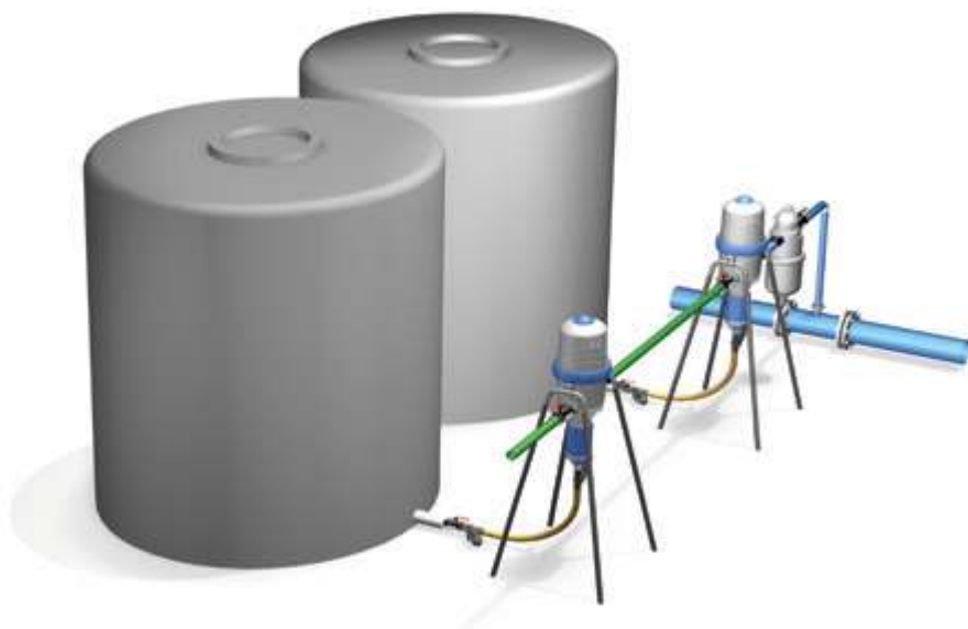
Типовая встроенная установка для моделей MixRite TF
