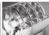
Вал и рабочие колеса из нержавеющей стали
