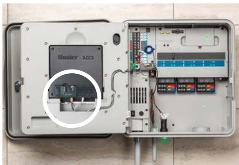
Контроллер ACC2 с установленным модулем A2C-CELL-E
