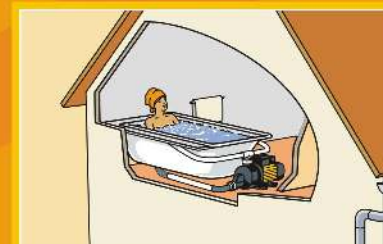
Рециркуляция воды в гидромассажном оборудовании
